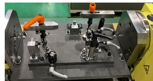
CFRP治具の試作例 (自動車部品用)
